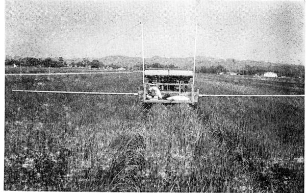
作業が主である。作業の高能率化のために現在盛んに整備の進められている大区画圃場では、これらの畦畔からの作業が不可能となり、泥田中の歩行作業を強いられるが、著しく過酷な作業であり、大規模稲作で長時間実施することはできないであろう。そこで、水田内乗用作業機として、トラクターに直装する作業幅10mの水平多口噴頭式散布機（定幅散布機）を開発することにした。
